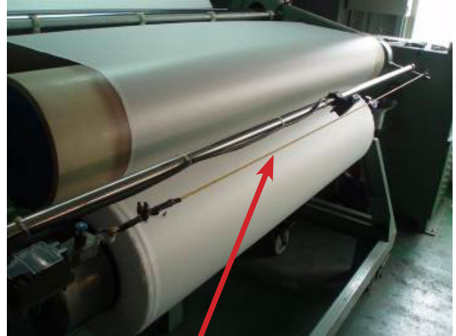
Lắp đặt dụng cụ khẩn cấp điều khiển chuyển động máy. 緊急制動裝置
