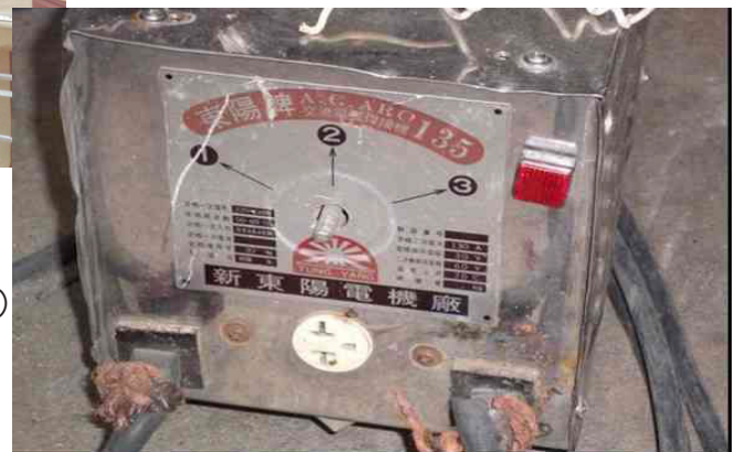
เครื่องเชื่อมไฟฟ้าที่ผู้เสียชีวิตใช้ทำงานในขณะที่นั้นไม่มีการติดตั้ง อุปกรณ์ป้องกันไฟช็อตอัตโนมัติ 罹災者作業時所使用之電焊機。(未有自動電擊防止裝置)
